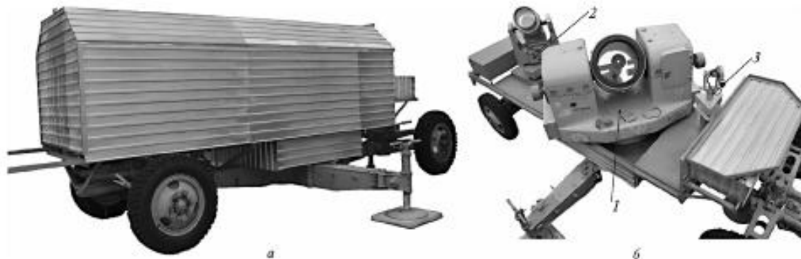
Рис. 1. Внешний вид комплекса телескопов МОБИТЕЛ: а — укрытие телескопа, б — транспортируемая платформа с телескопами
