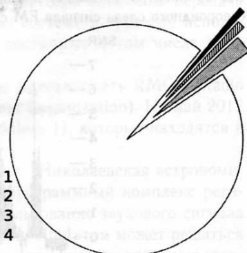
Рис. 4. Распределение явлений по суммарному времени существования за май 2012 года (поток \eta -аквариды): 1 — метеоры 0,83%; 2 — техногенные помехи 1,10%; 3 — температурная инверсия 2,51%; 4 — шум 95,56%
