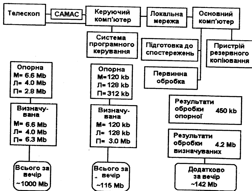
Рис. 2. Структура інформаційних потоків СПК АМК.
